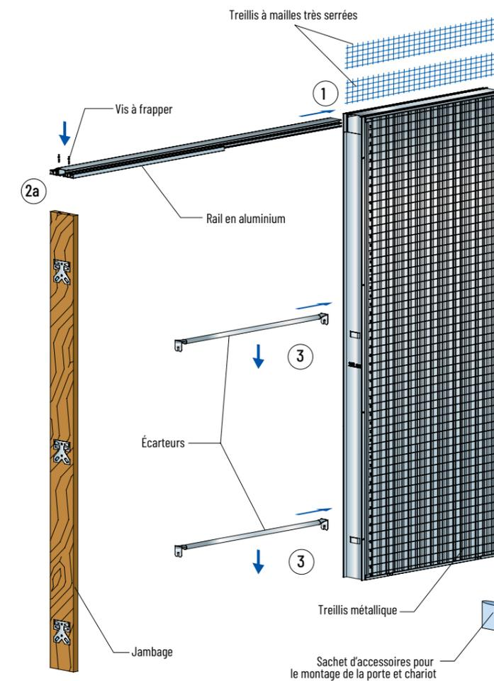
1. Insérer le rail dans le châssis.
