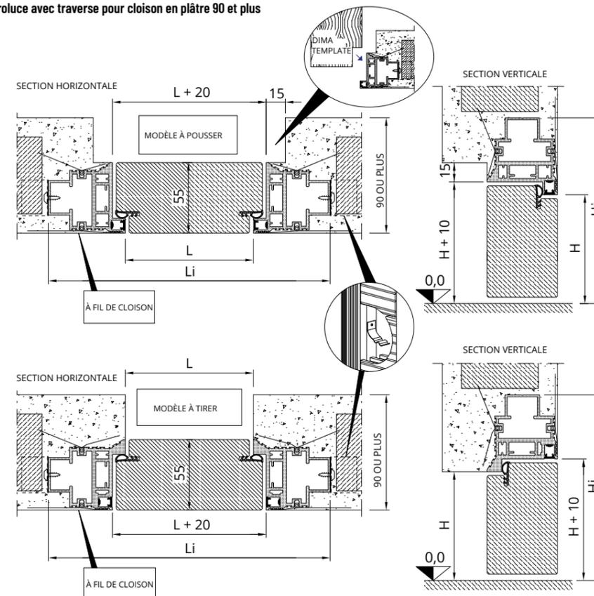
**Version Controluce avec traverse pour cloison en plaques de plâtre 75/100 mm**
