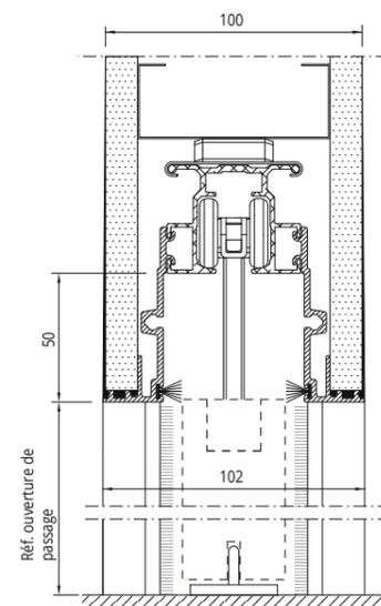
Cloison en maçonnerie de 105 mm
