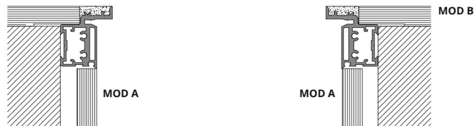
MONTAGE AVEC BATTENTE50 / PIUMA / RELAX / SENZA TRAVERSO / TRAPEZOIDALE / SYSTÈME ACOUSTIQUE À FIL DE CLOISON 100c/105i TIRER
