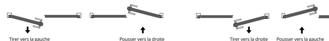
La version à pousser permet une ouverture maximale du vantail à 90° / 100°, réduisant de fait l'ouverture de passage.
