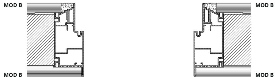
MONTAGE AVEC BATTENTE50 / PIUMA / RELAX / SENZA TRAVERSO / TRAPEZOIDALE / SYSTÈME ACOUSTIQUE À FIL DE CLOISON 100c/105i POUSSER
