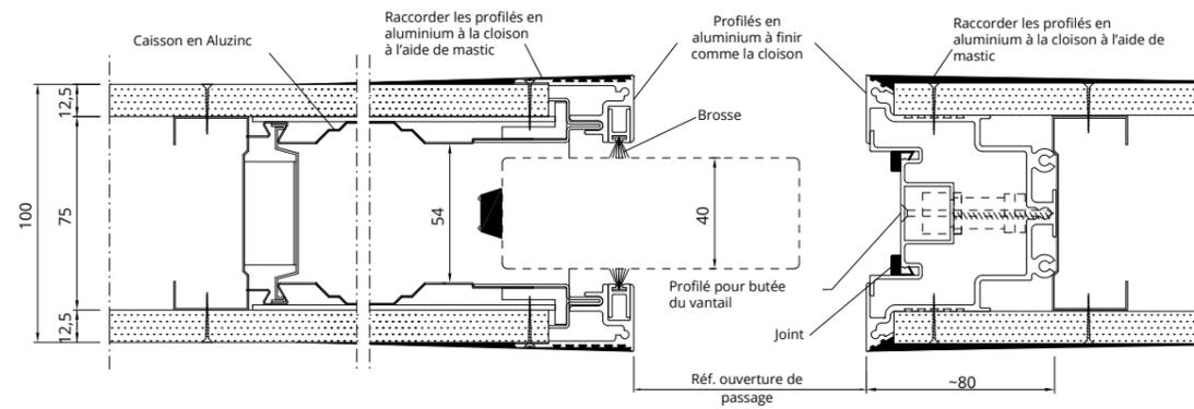
Galndage pour vantail coulissant escamotable sans habillages pour cloison en maçonnerie de 105 mm.
