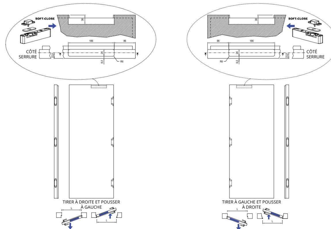
Système de fermeture amortie pour porte battante à fil de cloison PIUMA. Softclose assure l'accompagnement de la porte dans les derniers 10° de fermeture. Capacité maximale de 40 kg. Utilisable sur des panneaux d'une largeur maximale de 900 mm.
