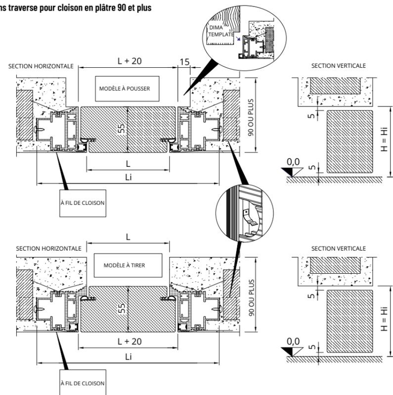
Version Controluce sans traverse pour cloison en plaques de plâtre 75/100 mm
