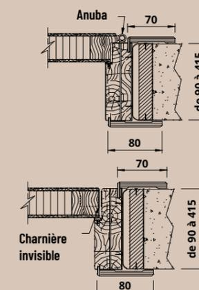
Habillages battants avec joint, couvre-joint plat de 70x10 mm côté charnière, plat du côté opposé dimensions 80x10 mm.
