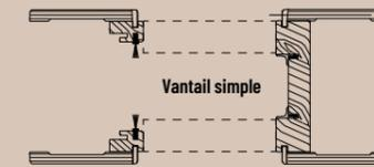
Habillages réalisés principalement en sapin jointé plaqué frêne pour la finition frêne laqué, avec brosse à poussière et joint. L'habillage devra toujours être adapté à l'ouverture de passage lors de l'installation, en effectuant de simples découpes. Le couvre-joint est disponible avec des rabats de 5 mm ou de 15 mm
