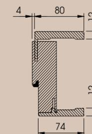
Habillages battants avec un rayon de 1,5 mm, avec joint, couvre-joint plat emboîtable de 74 mm du côté du vantail, plat du côté opposé dimension 80 mm avec rabat. Habillages réalisés en MDF hydrofuge, conservant les caractéristiques du MDF normal et y ajoutant la résistance à l'humidité grâce à l'utilisation d'adhésifs spécifiques. Couvre-joints en MDF.
