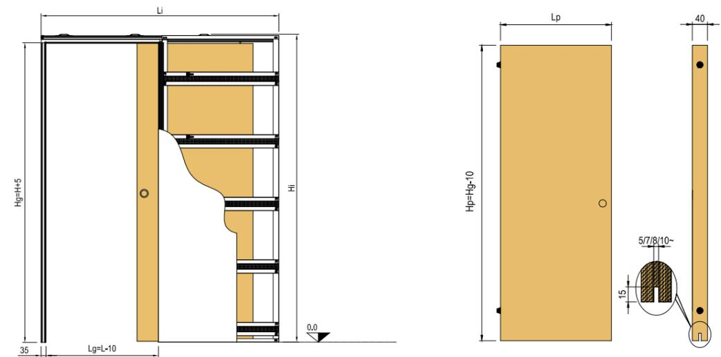
Pour les cloisons en plaques de plâtre de 100 mm - galandage : pour une structure de 75 mm + 1 plaque de 12,5 par côté
