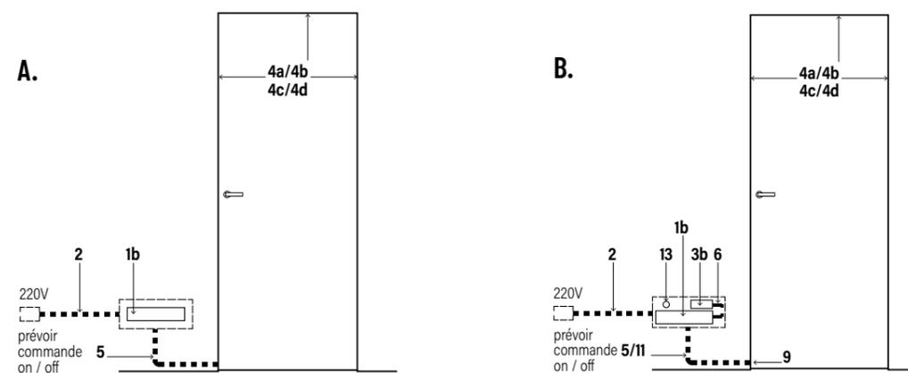
A. Fonctionnement.: allumage et extinction par dispositif (non fourni) sur alimentation principale.
