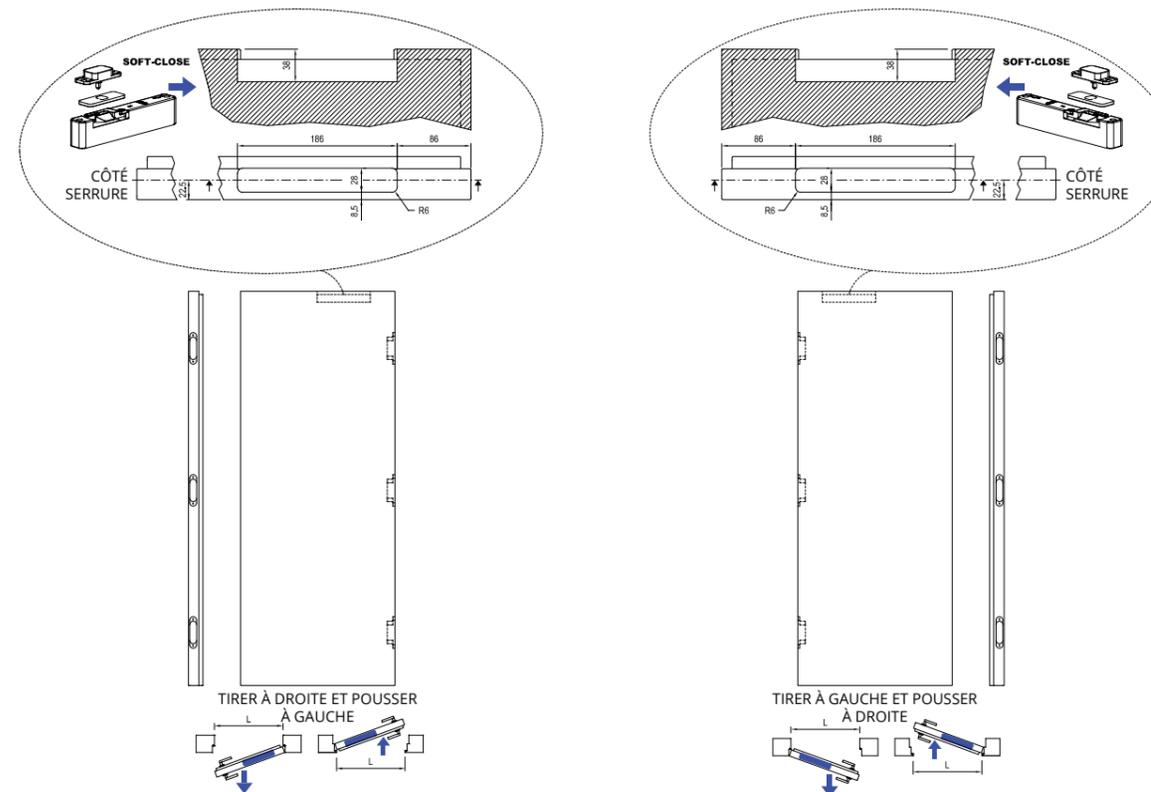
Systeme de fermeture amortie pour porte battante à fil de cloison PIUMA. Softclose assure l'accompagnement de la porte dans les derniers 10° de fermeture. Capacité maximale de 40 kg. Utilisable sur des panneaux d'une largeur maximale de 900 mm.
